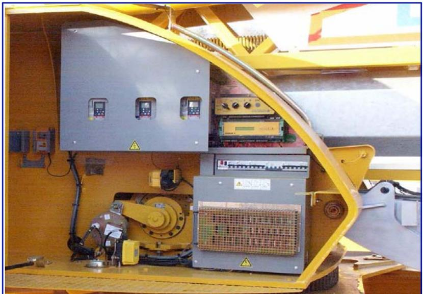
**Anmerkung:** Um die Sicherheit der Hydraulikpumpen zu gewährleisten, ist ein Detektor der Phasenfolge integriert. Wenn er beim Einschalten nicht funktioniert, muß die Phasenfolge kontrolliert werden.
