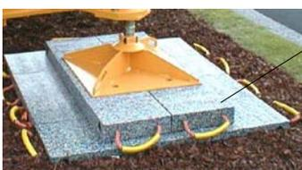
Fußplatten aus Verbundwerkstoff (verfügbar bei Crane CARE). Ersetzen vorteilhaft die Abstützungen aus Holz. Sehr widerstandsfähig, leicht zu handhaben. Nehmen keine Nässe auf, verfaulen nicht.
