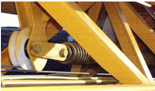
Feder zur Spannung des Katzseils
