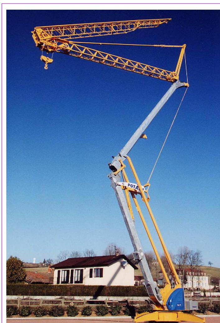
**==> AUSRICHTEN DES AUSLEGERS: erfolgt nach kompletter Ballastierung.
