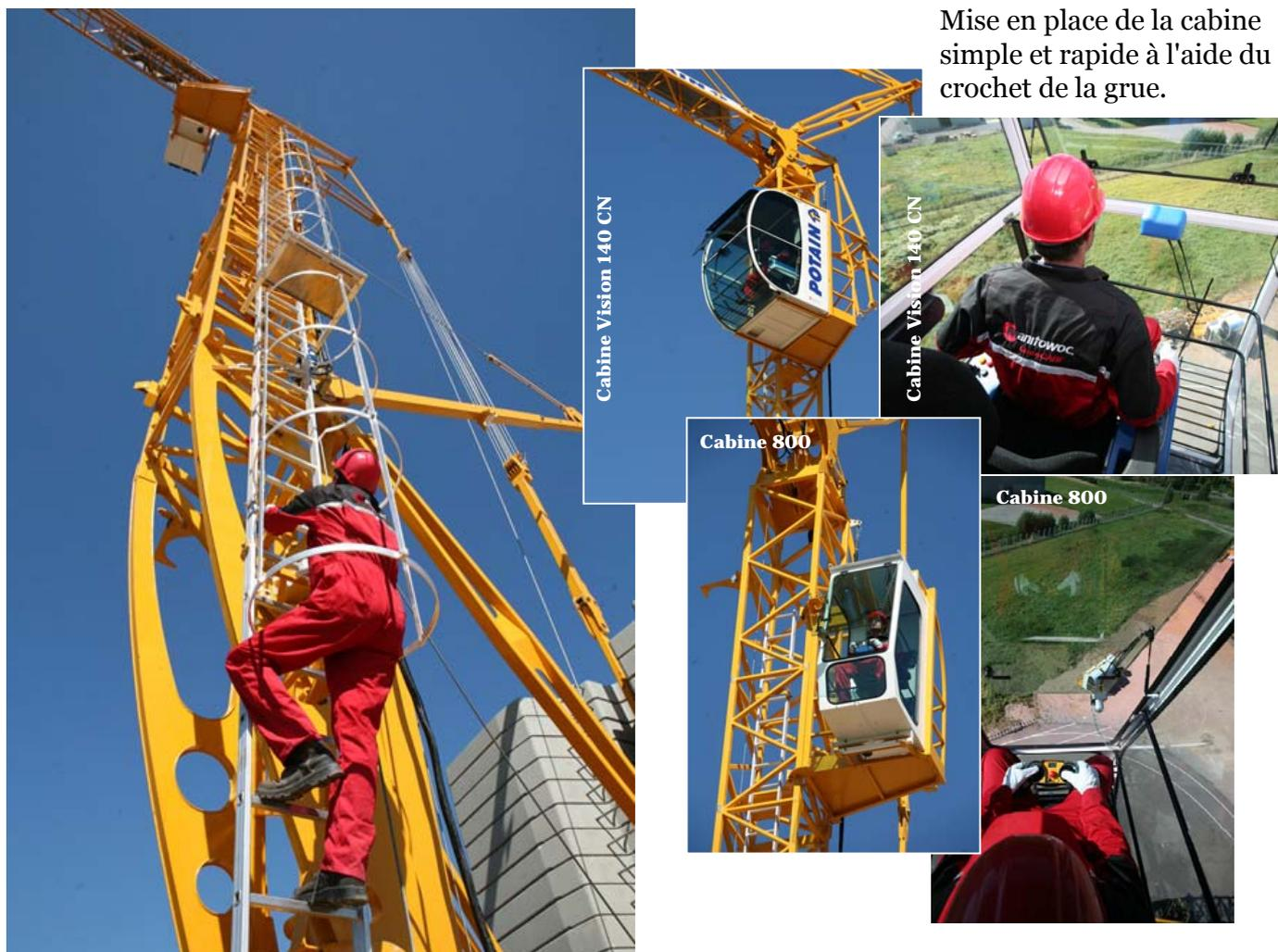
Mise en place de la cabine simple et rapide à l'aide du crochet de la grue.
