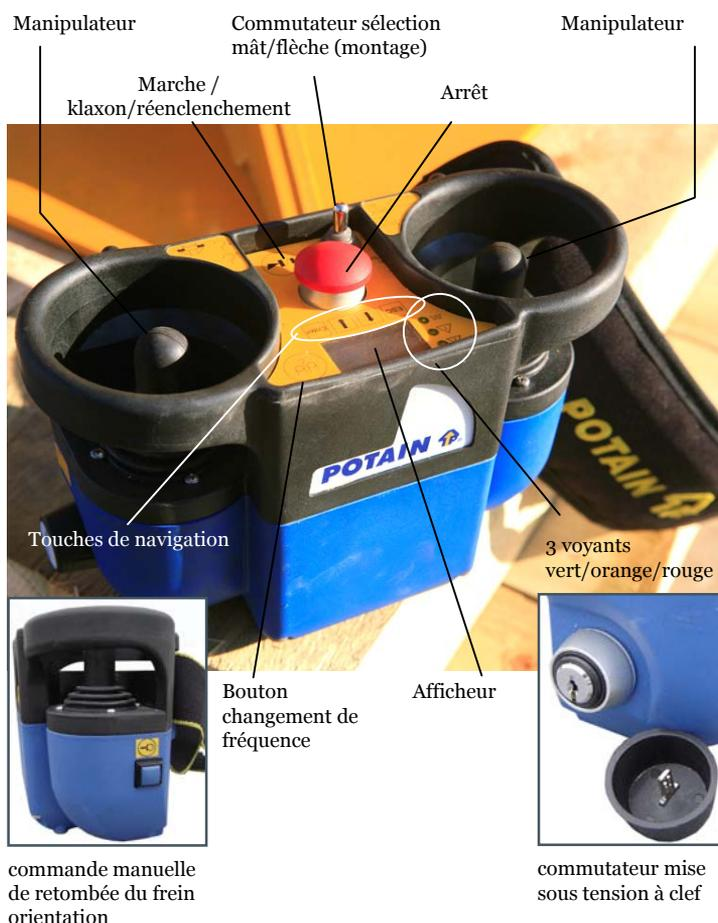
Le poste émetteur est livré avec 2 batteries de 3,6 V et un chargeur situé dans l'armoire électrique.
