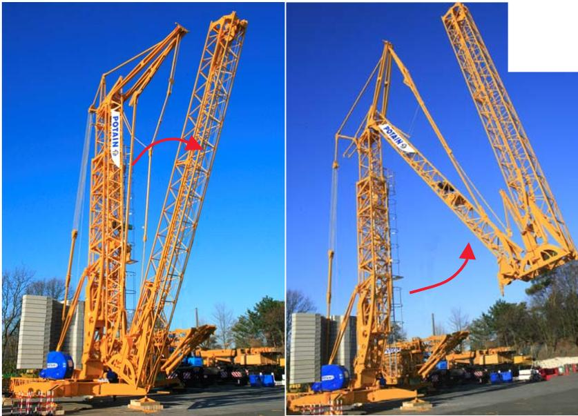
Le relevage de la flèche est entièrement assuré par le treuil de retenue.
