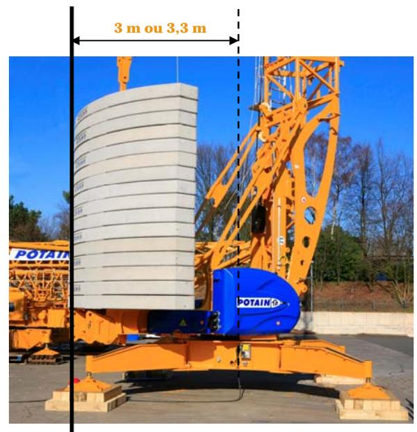
En plus , le châssis est équipé d'un **support de lest escamotable** (fourni en standard) :
