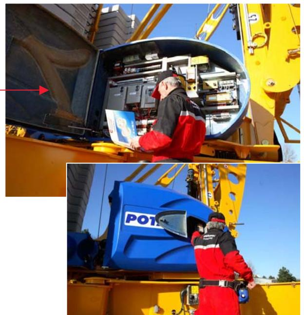
Sécurité optimale grâce à une double ouverture de l'armoire électrique.
