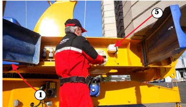
**Limiteur de course de télescopage (5)** a pour rôle de pallier à d'éventuelles erreurs de montage/démontage (insertion/retrait d'un mât rallonge, dételescopage...) de la grue. Il coupe le mouvement de retenue descente avant le déroulement complet du câble.
